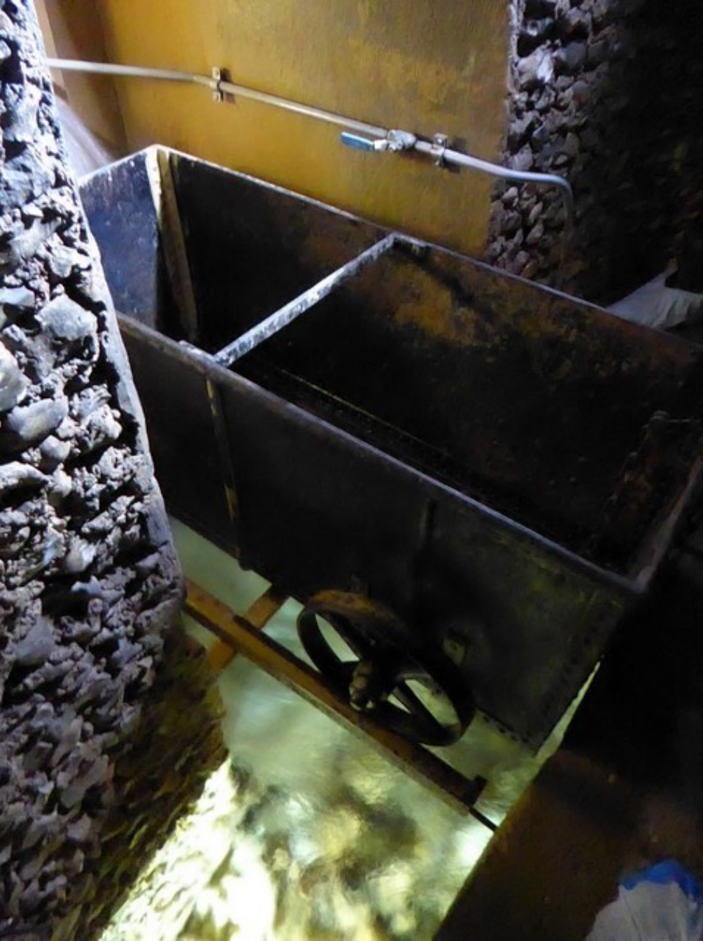
Chariot permettant d'effectuer un jaugeage (mesure de débit) au niveau de la galerie acheminant l'eau captée depuis la source de la Bouillarde.
